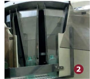
Il canale di discesa guiderà la bottiglia fino all'uscita dalla macchina e, una volta lì, sarà depositata sul trasportatore di uscita. L'uscita può essere di due tipi: trasportatore a nastro aspirato (3), per bottiglie con base piana, o sistema di estrazione a stella e trasportatore aereo POSIJET (4), per bottiglie con base petaloide.
