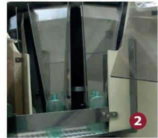
L'entonnoir guide la bouteille jusqu'à la sortie de la machine, où elle est déposée sur le convoyeur de sortie. Il existe deux types de sorties : sur convoyeur à bande avec aspiration (3), pour les bouteilles à fond plat, ou sortie en étoile avec convoyeur à air POSIJET (4) pour les bouteilles à fond pétaloïde.
