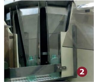
Der Trichter führt die Flasche bis zum Ausgang der Anlage. Sobald sie dort ankommt, wird sie auf dem Auslaufband abgesetzt. Der Austritt der Flaschen kann auf zwei Arten erfolgen: mittels eines Vakuumbandes (3) für Flaschen mit flachem Boden oder mittels Lufttransporteurs vom Typ POSIJET (4) für Flaschen mit Petaloidboden.
