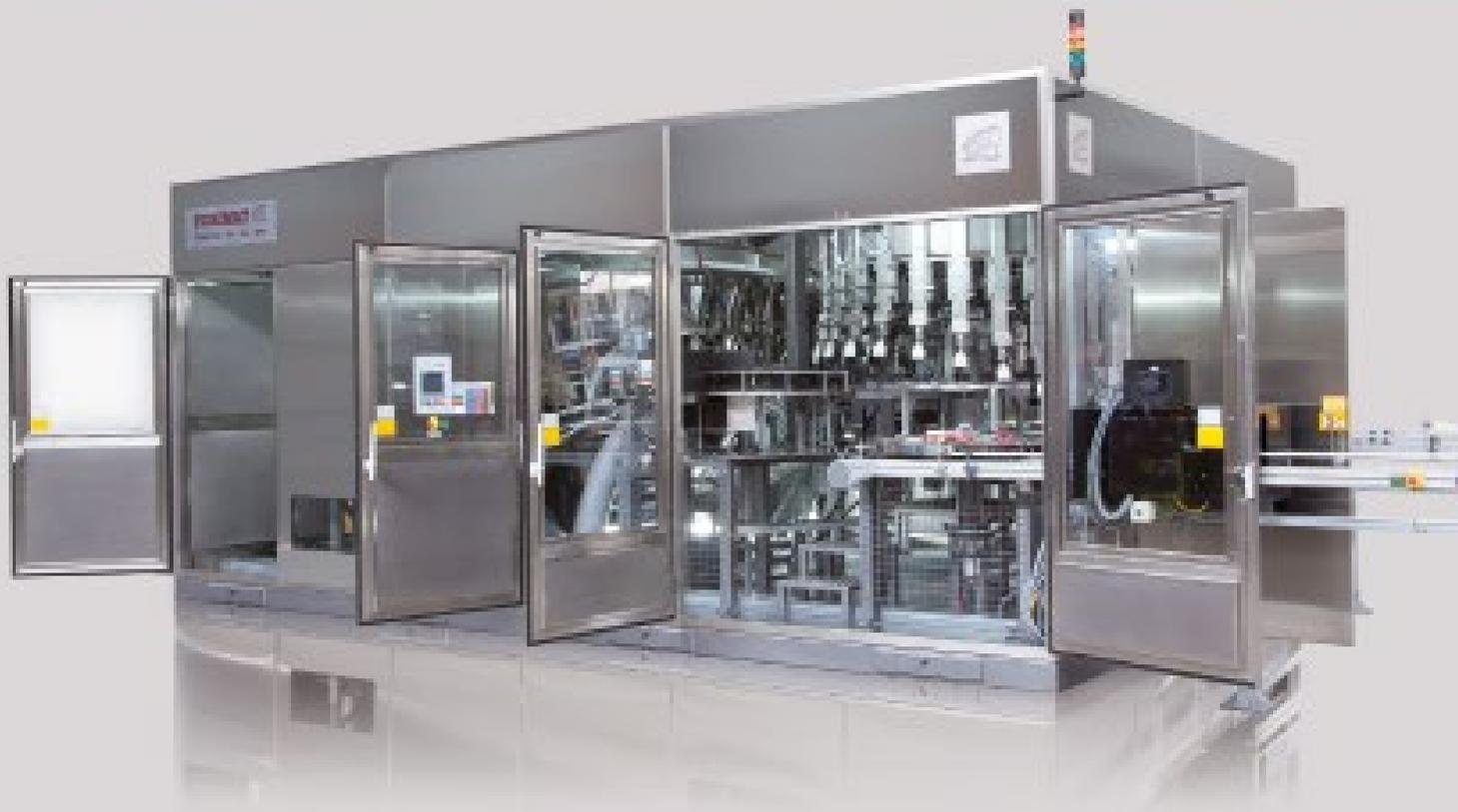
ACCESS 系统配有一个外罩，可**通过这里**完全进入机器内部，便于**对机器**进行检查、维护和清洁。
