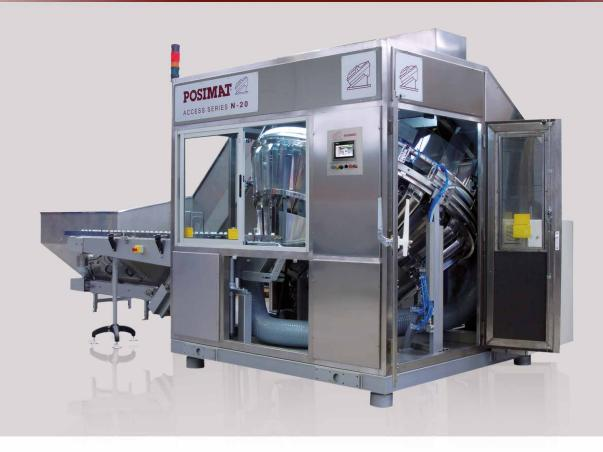
El sistema ACCESS cuenta con una cabina que permite total acceso al interior del equipo, lo que facilita las tareas de inspección, mantenimiento y limpieza.
