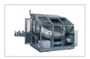
Cabinas completamente cerradas de paneles practicables y puertas de fácil acceso para realizar cambios de formato y trabajos de limpieza e inspección. Disponible en dos tipos de acabado: acero plastificado o acero inoxidable AISI 304, con insonorización de 80dB(A), así como cabinas con una mayor insonorización de hasta 75dB(A).
