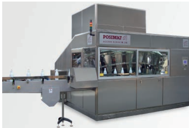
不锈钢外罩, 配直板内置送料仓, 适用于 N-35 型理瓶机的
