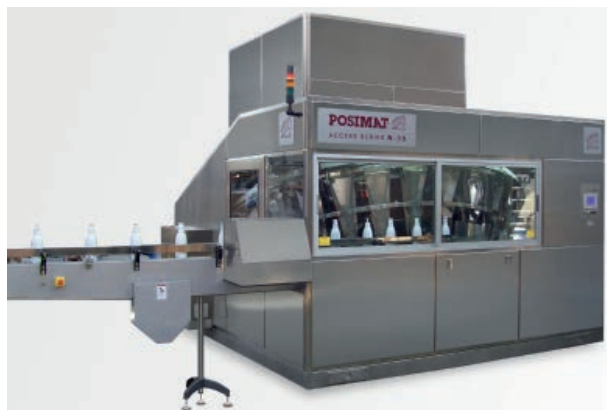
Кабина из нержавеющей стали для установщика модели N-35 с интегрированным моноблочным питающим бункером
