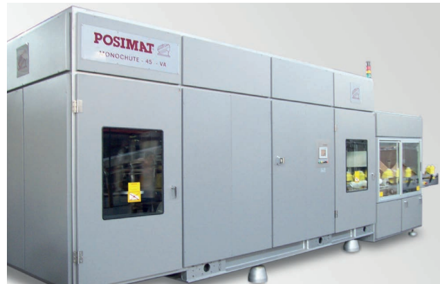
Cabina de acero plastificado para posicionador modelo MONOCHUTE-45 con Orientador rotativo incorporado en monoblock
