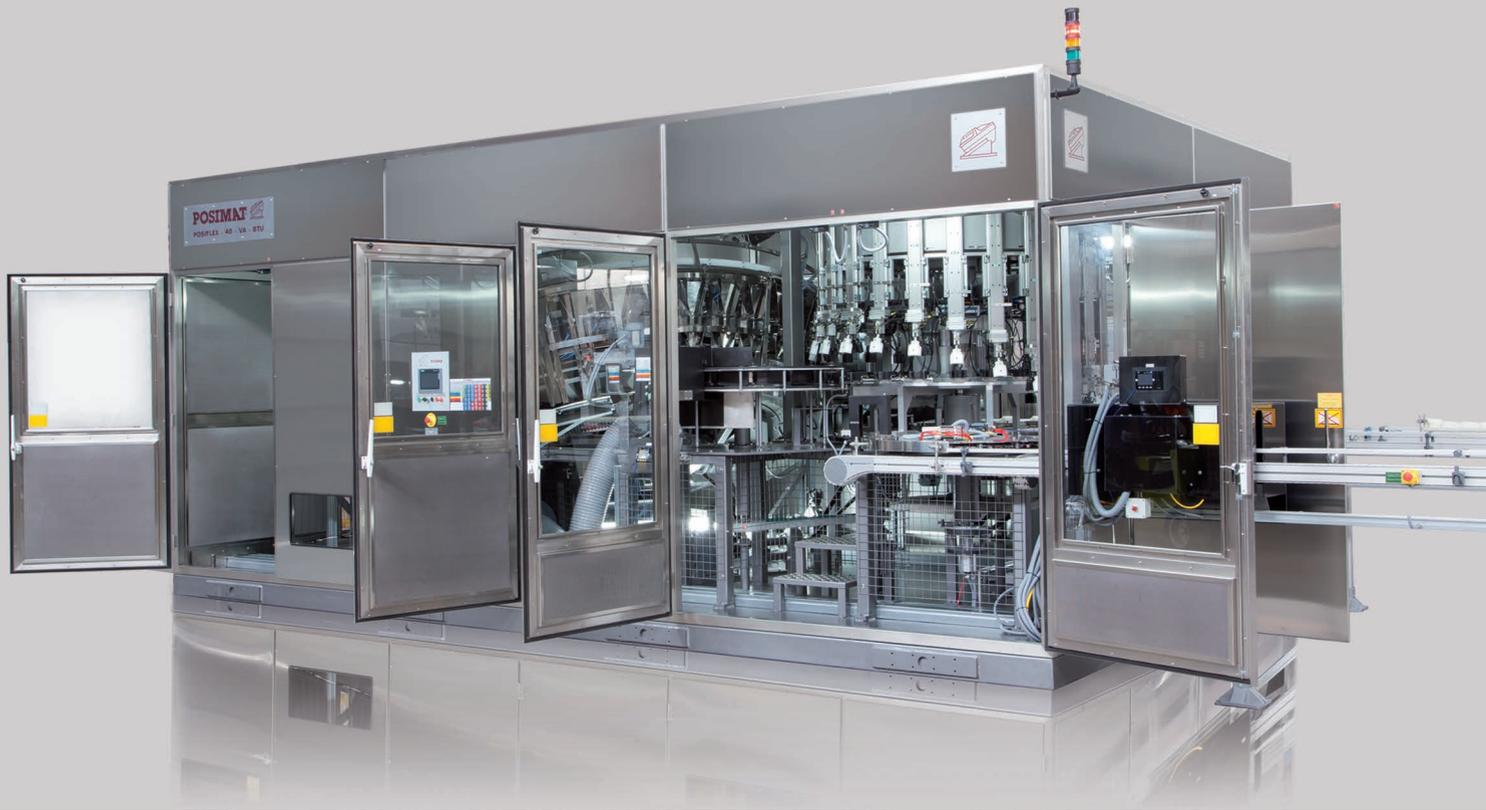
El sistema ACCESS cuenta con una **cabina** que permite **total acceso al interior** del equipo, lo que **facilita las tareas** de inspección, mantenimiento y limpieza.
