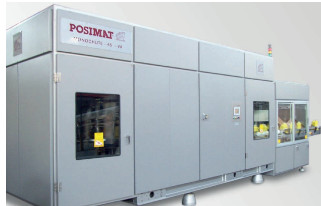
Kabine aus kunststoffbeschichtetem Stahl für Flaschenaufrichter Modell MONOCHUTE-45 mit integriertem rotativem Flaschenausrichter
