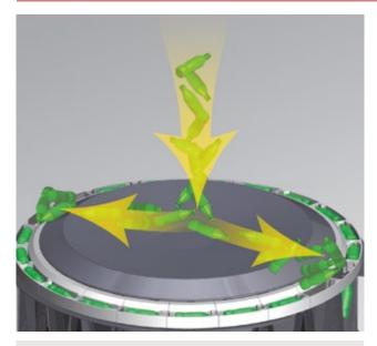
MULTICHUTE型具备的多溜槽进瓶系统能使顶部转盘里的瓶子分别走向两个进料区域,因此,转盘每转一次,每一个料斗就能处理两个瓶子(简易系统或传统系统仅处理一个)。
