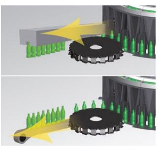
根据不同项目的特定要求,卸料轮的瓶子可通过 气动输送机(POSIJET)或链式输送机被运至生产 线。
