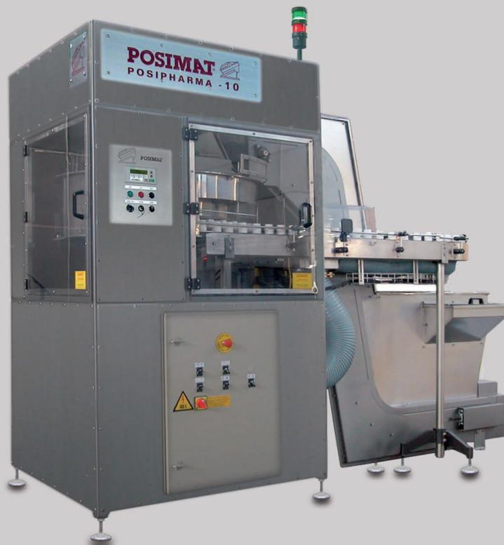
POSIPHARMA型理瓶机用于整理罐子、广口瓶盖和大直径瓶，其生产速度最高达300 bpm/分钟
