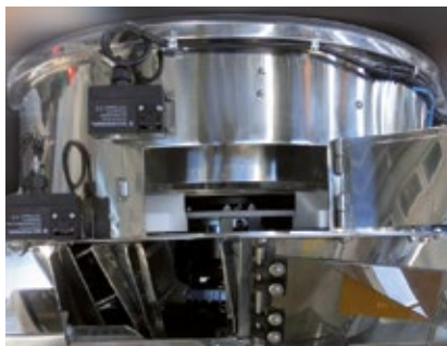
更换选定槽和料斗的出入口
