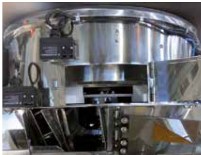
Zugangstüren zu den Zentrierfächern zur Durchführung des Formatwechsels
