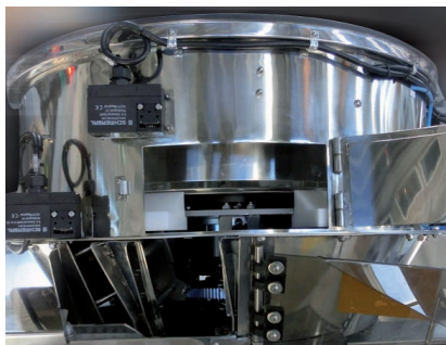
更换选定槽和料斗的出入口
