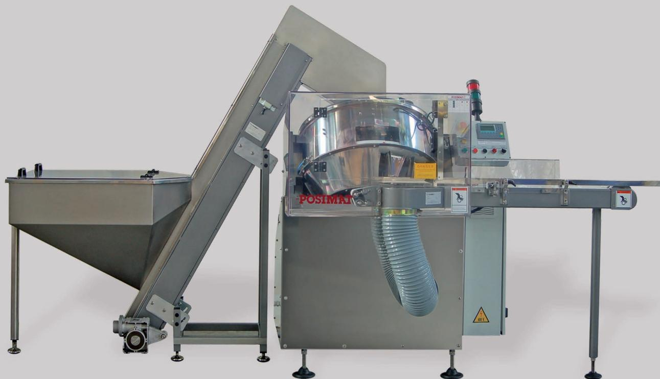
I riordinatori **MICRO** sono progettati per **bottiglie e fiale** in produzioni fino a 200 bpm. È un modello molto compatto principalmente in acciaio inossidabile, il cui cambio di formato si esegue in meno di 5 minuti.
