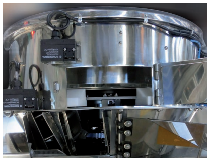
Puerta de acceso a las piezas selectoras para realizar el cambio
