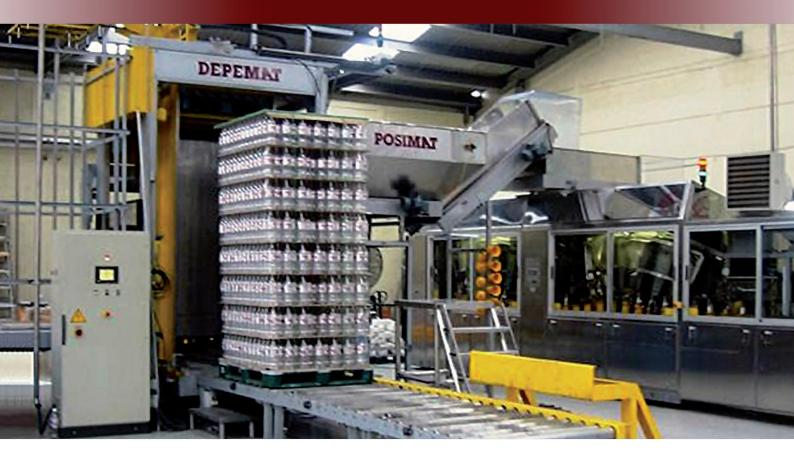
Депалетизатор Depemat – это полностью автоматизированная машина, предназначенная специально для простой и надежной разгрузки пластиковых бутылок с поддонов, перед тем как помещать их в бункер грузоподъемника установщика Posimat.
