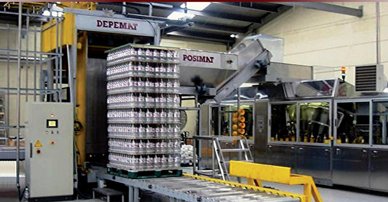
Le dépalettiseur Depemat est une machine entièrement automatique, spécialement conçue pour dépalettiser les bouteilles en plastique à partir de palettes, de façon simple et fiable, avant de les introduire dans la trémie de l'élévateur de chargement du redresseur Posimat.
