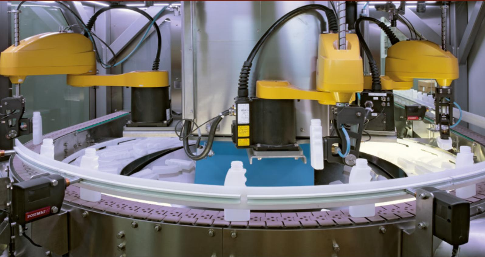
Revolutionieren Sie Ihren Prozess zum Aufrichten von leeren Flaschen und Kunststoffbehältern mit dem neuen COMPACTBOT von POSIMAT, einem roboter-gestütztem Flaschenaufrichter im Rundlauf.
