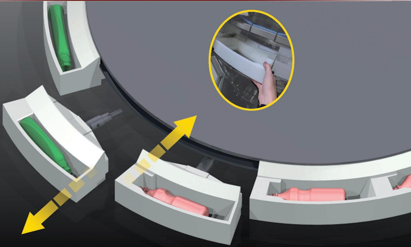
Смена комплектов ячеек и воронок, предназначенных для различных видов бутылок, выполняется вручную.
