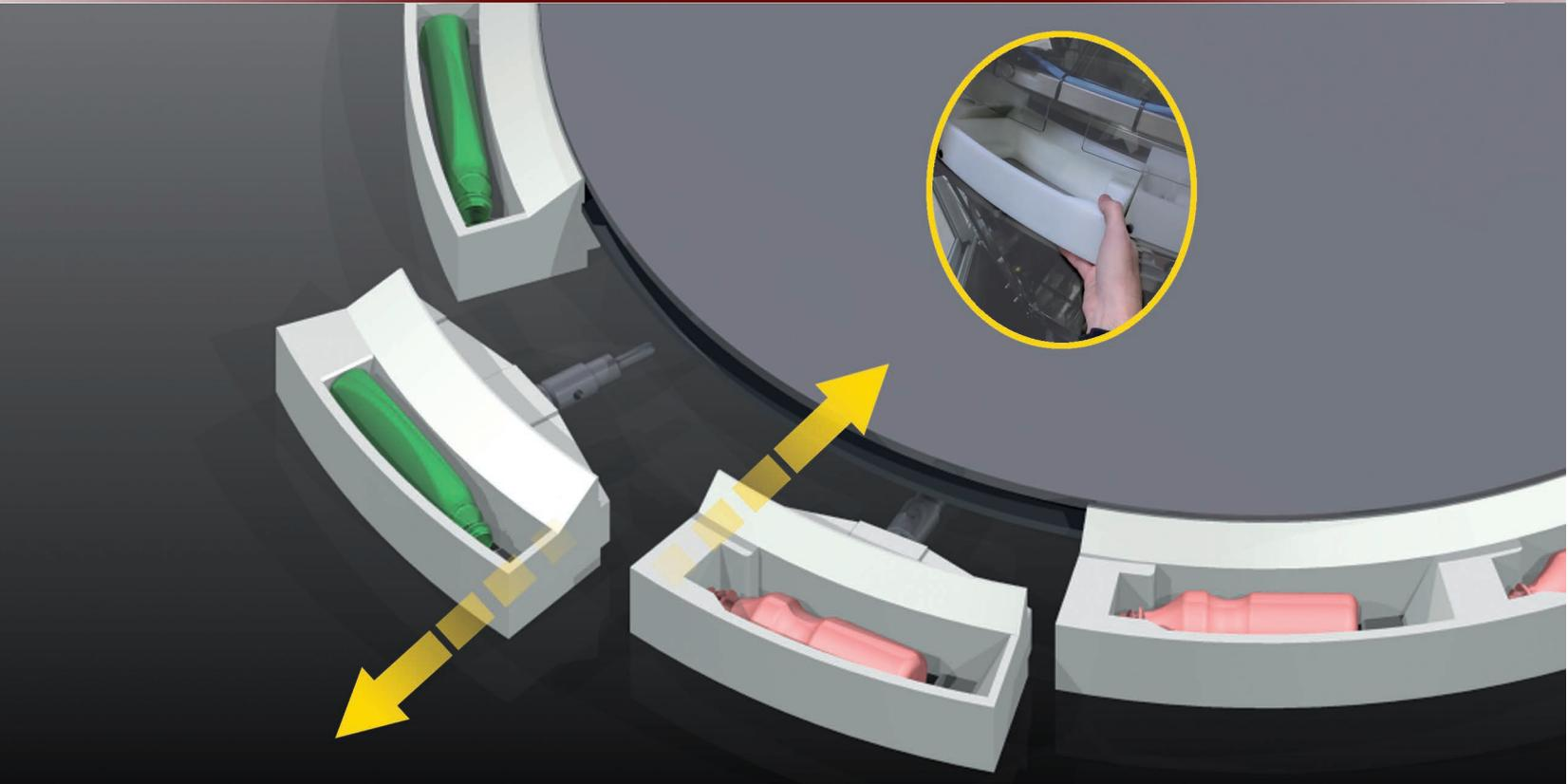
Manueller Formatwechsel mittels der auf die einzelnen Flaschen zugeschnittenen Zentrierfächer und Aufrichttrichter, die es zu positionieren gilt.
