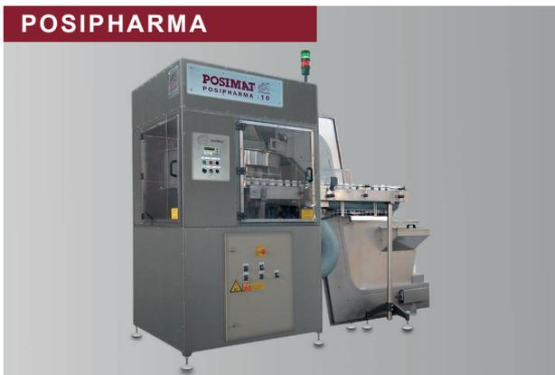
Предназначена для контейнеров с широким горлышком и крышками большого диаметра, производительностью до 300 бут./мин. с быстрой системой смены формата, не требующей применения инструментов.
