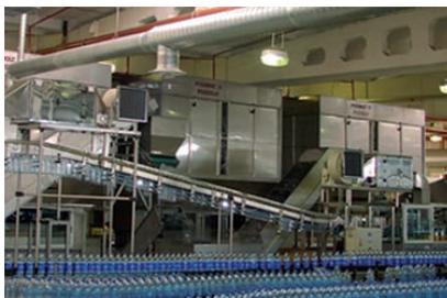
Ориентатор, силоса и пневматический транспортер
