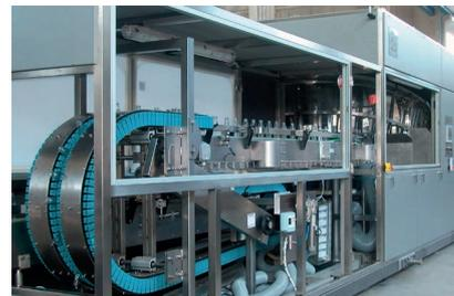
Устройства промывки с использованием воздуха
