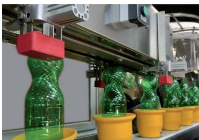
**POSITRANS:** Для контейнеров с лепестковым дном + пневматический конвейер POSIJET.
