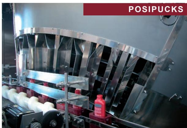
Это высокопроизводительный ориентатор, предназначен для работы с контейнерами всех типов, любых форм, и в особых случаях, когда дизайн контейнера требует особенного контроля в процессе ориентирования. Бутылки могут подаваться на выходной конвейер, как в держателях, так и без них (POSIPUCK).
