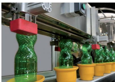
POSITRANS: pour les bouteilles à fond pétaloïde + convoyeur à air POSIJET .
