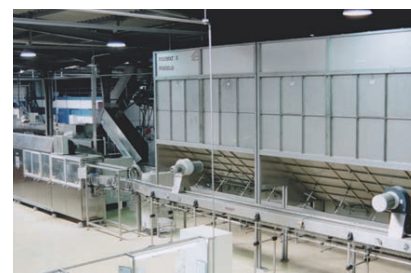
Installation de redresseur, silos et convoyeur à air
