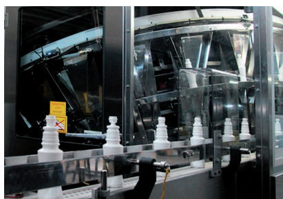
CONVOYEUR PAR LE VIDE: pour les bouteilles à fond plat.
