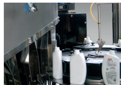
ÉTOILE DE TRANSFERT: pour les bouteilles à forme spéciale.
