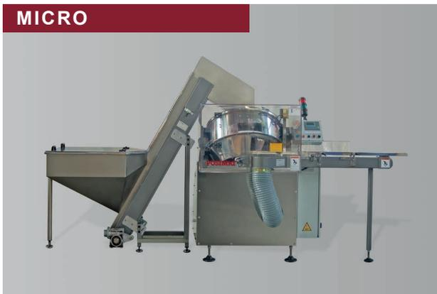
Una solución para posicionar botellas y frascos a producciones de hasta 200 bpm. Se trata de un modelo muy compacto, cuyo cambio de formato se realiza sin ajustes ni herramientas.
