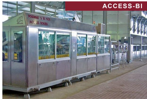
POSIMAT hat dieses System speziell für Kunden entwickelt, die mit Transportbechern (Pucks) ausgestattete Systeme einsetzen. Das System sorgt für höhere Stabilität der Flaschen, Flexibilität und Geschwindigkeit der Formatumstellungen, wie es häufig in der Kosmetikindustrie erforderlich ist.
