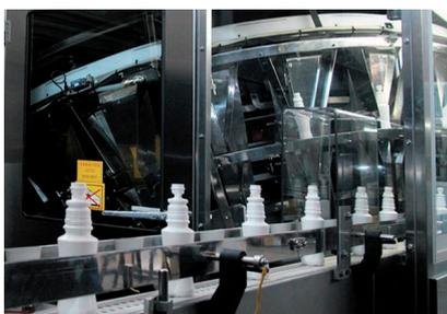
**VAKUUMFÖRDERER:** für Flaschen mit flachem Boden.
