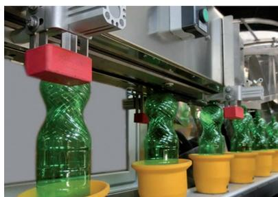
**POSITRANS:** für Flaschen mit Petaloidboden + Lufttransportsystem **POSIJET**.
