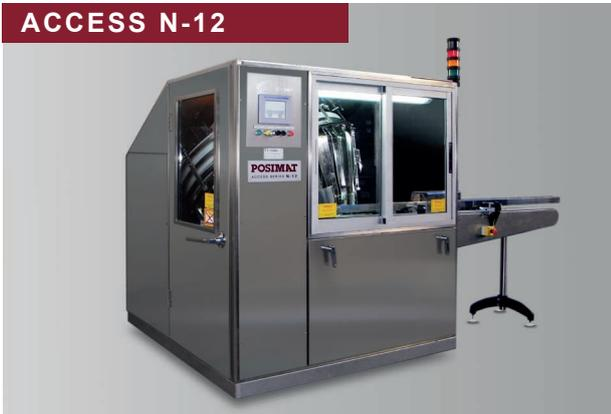
Kompakter Flaschenaufrichter, vollständig aus Edelstahl. Geeignet für zahlreiche Flaschenformen.
