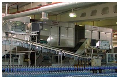
Flaschenaufrichter, Silos und Luftfördereranlage
