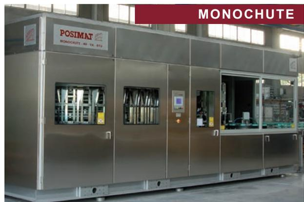
ist mit einem neu gestalteten System mit mehreren Fallschächten ausgestattet, was diesen High-Speed-Flaschenaufrichter zu einer kostengünstigen und kompakten Lösung macht.
