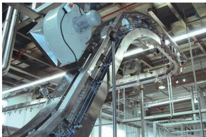
Vertikale Führung des Luftförderers
