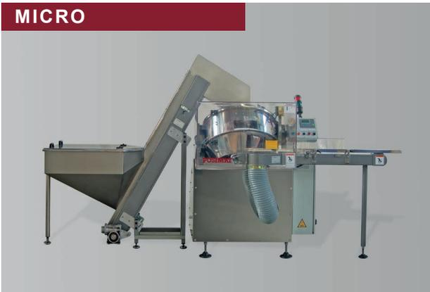
Eine Lösung zum Aufrichten von Flaschen und Flakons mit einer Höhe von bis zu 140 mm für eine Produktionsleistung bis 200 Fl./Min. Ein ultrakompaktes Modell, das keine Werkzeuge zur Durchführung der Einricht- und Umstellarbeiten erfordert.
