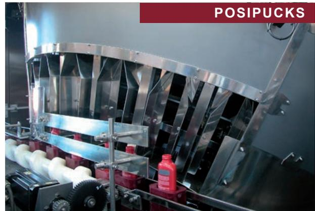
Ein High-Speed-Flaschenaufrichter für Flaschenformate und -formen aller Art, insbesondere für Fälle, bei denen das Design der Flasche eine verbesserte Kontrolle des Aufrichtvorgangs erfordert.
