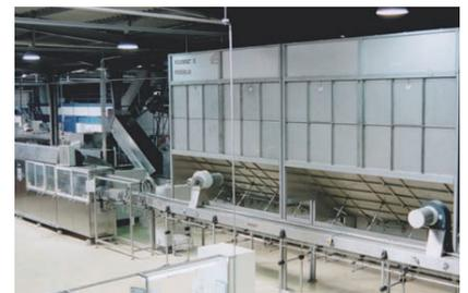
Flaschenaufrichter, Silo und Luftfördereranlage
