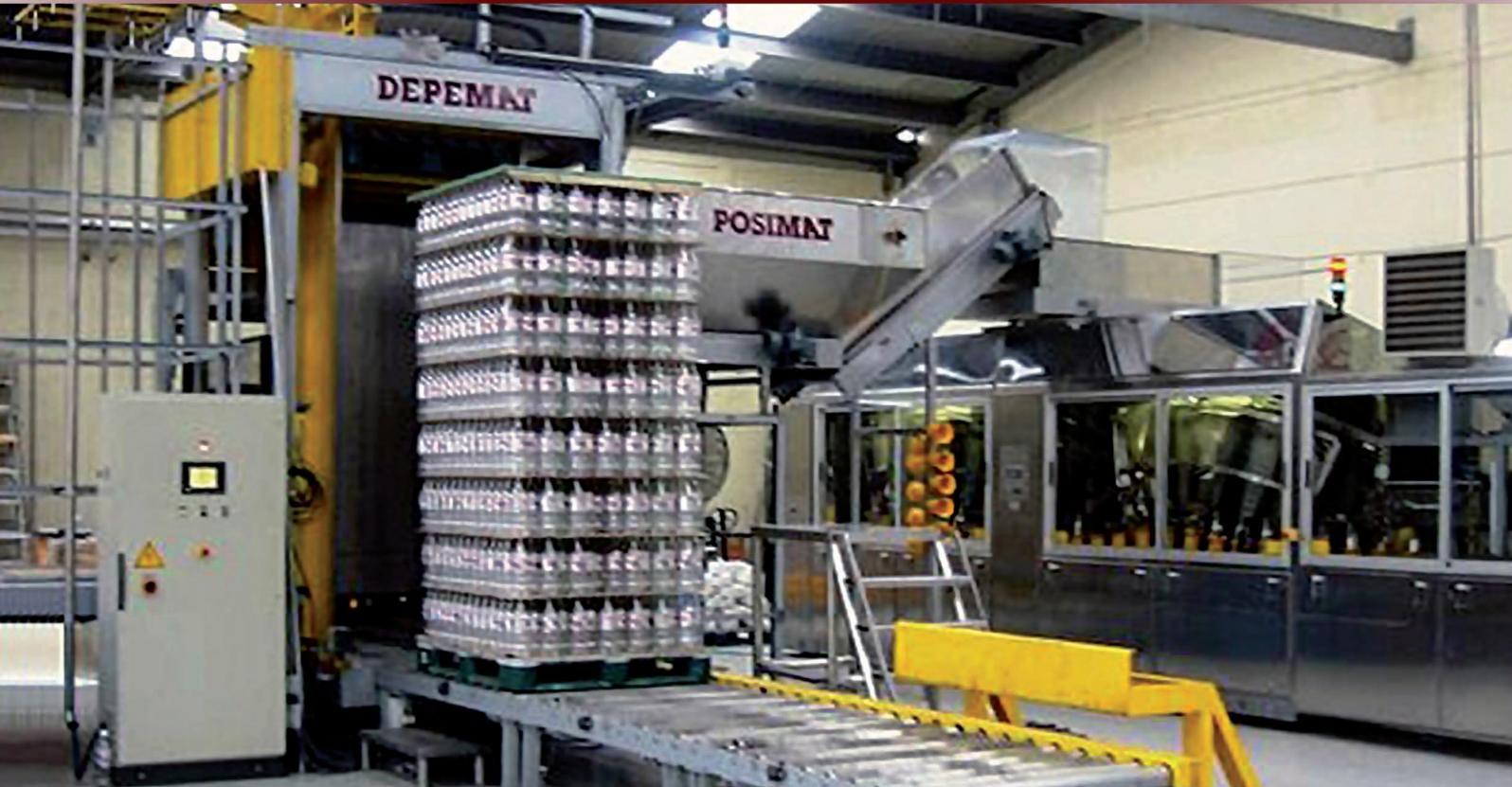
DEPEMAT 卸垛机是一款操作简单的全自动设备，用于将塑料空瓶子从托盘中移除在塑料空瓶在装入 Posimat理瓶机料斗和提升机之前卸下。
