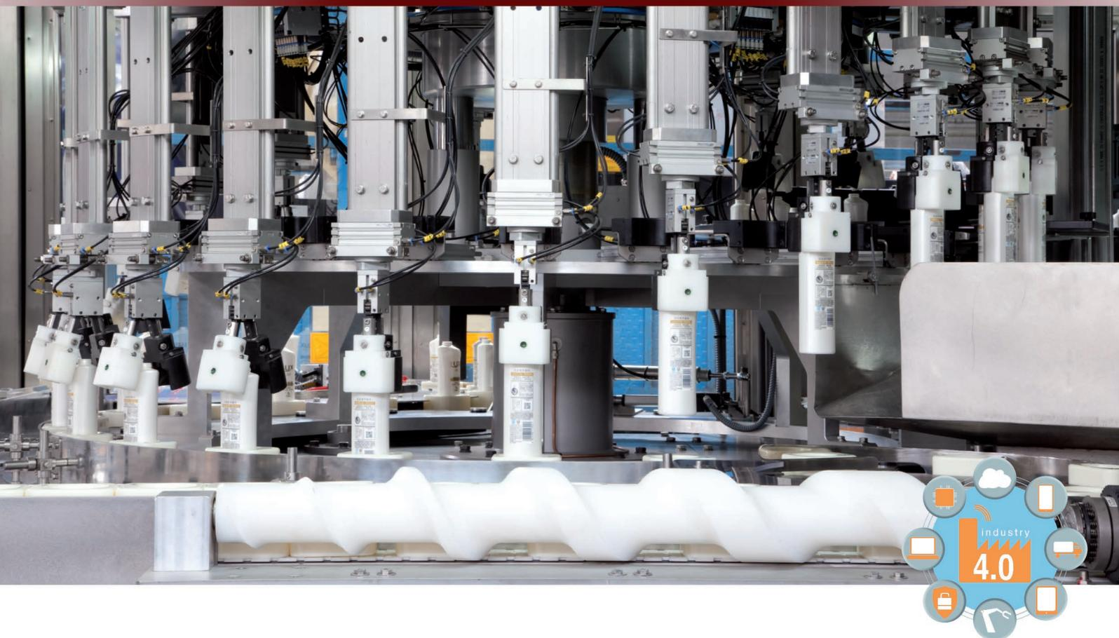
La combinaison redresseur et **BTU** (Bottle Transfert Unit, ou système de transfert de bouteilles) **permet d'envoyer les bouteilles instables jusqu'à la remplisseuse, de manière sûre**, et de permettre leur manipulation pendant l'ensemble du processus d'embouteillage.
