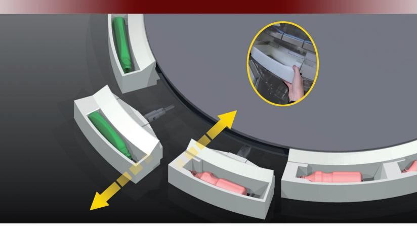
Cambio di formato manuale con separatori e canali di discesa progettati per ognuna delle bottiglie da riordinare.
