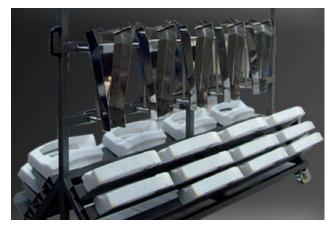
Per lo stoccaggio dei separatori e dei canali di discesa, POSIMAT fornisce opzionalmente carrelli porta formato.
