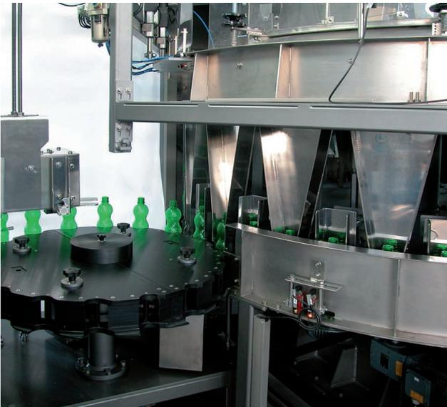
La estrella de salida vacía tanto los embudos principales como los auxiliares de manera que puedan ser llenados de nuevo en la siguiente rotación de disco.
