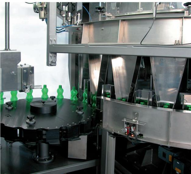
Der Auslaufstern übernimmt die Flaschen gleichzeitig von beiden Fallschächten, dem Haupt- und dem Zusatzschacht, damit diese bei der nächsten Umdrehung der Sortierscheibe erneut befüllt werden können.
