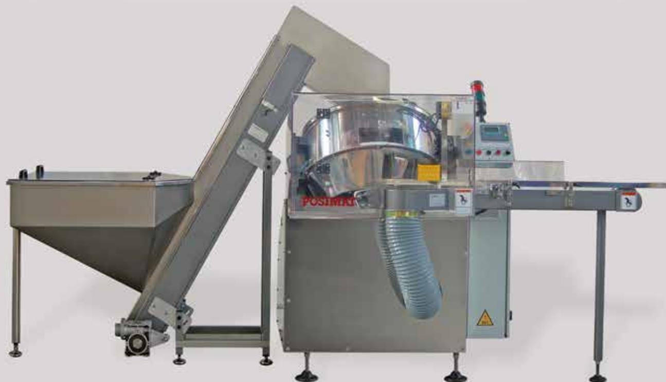
Les redresseurs **MICRO** sont conçus pour le positionnement de **petit flacons** à une cadence de production allant jusqu'à 200 bouteilles par minute. Ce modèle compact fabriqué principalement en acier inoxydable, permet de changer de format en moins de 5 minutes.
