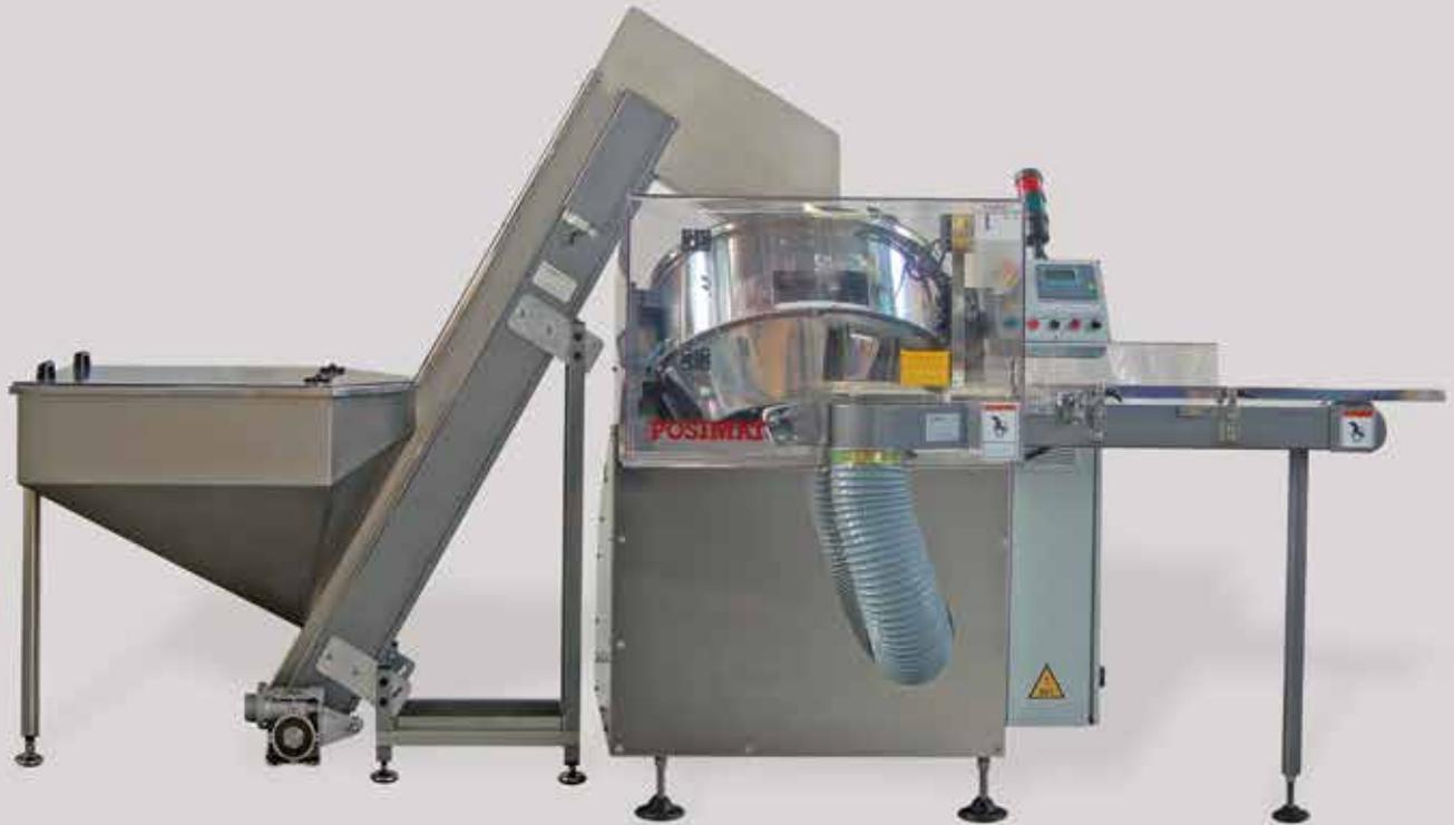
Der Flaschenaufrichter **MICRO** wurde für **Kleinstfläschchen** bei einer Produktionsgeschwindigkeit von bis zu 200 Fl./Min. entwickelt. Es handelt sich um ein sehr kompaktes Modell grösstenteils aus rostfreiem Stahl, bei dem der Formatwechsel in weniger als 5 Minuten dauert.
