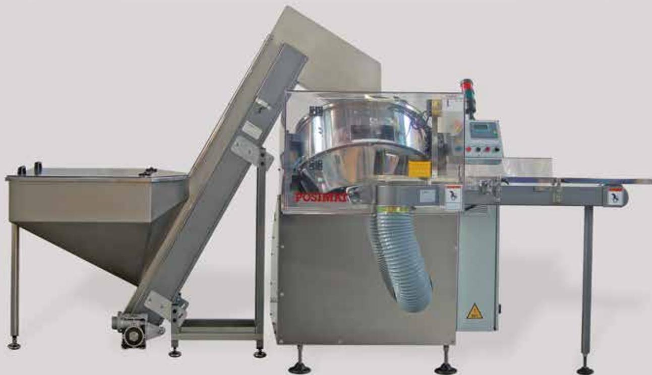
MICRO型理瓶机专为小型瓶子和小药瓶而设计，其生产速度可达 200 bpm (瓶/分钟)。MICRO是一套非常紧凑的机型，由不锈钢制成，具有可在5分钟内完成换瓶的快速更换功能。
