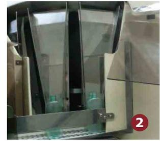
El embudo guiará la botella hasta la salida de la máquina, y una vez allí, esta será depositada en el transportador de salida. La salida puede ser de dos tipos: transportador aspirado de banda (3), para botellas de base plana, o salida en estrella y transportador aéreo POSIJET (4), para botellas de base petaloide.
