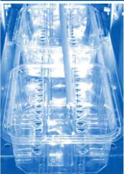
*Transportador por aire para envases vacíos; estuches, cajas o bandejas de distintos materiales.*
