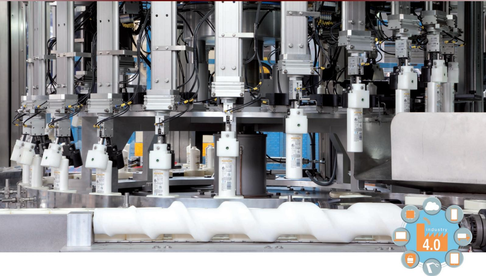
Die Kombination aus Flaschenaufrichter und **BTU (Flaschentransfereinheit)** ermöglicht es, **instabile Flaschen sicher zum Füller** und durch die gesamte Abfülllinie zu transportieren.
