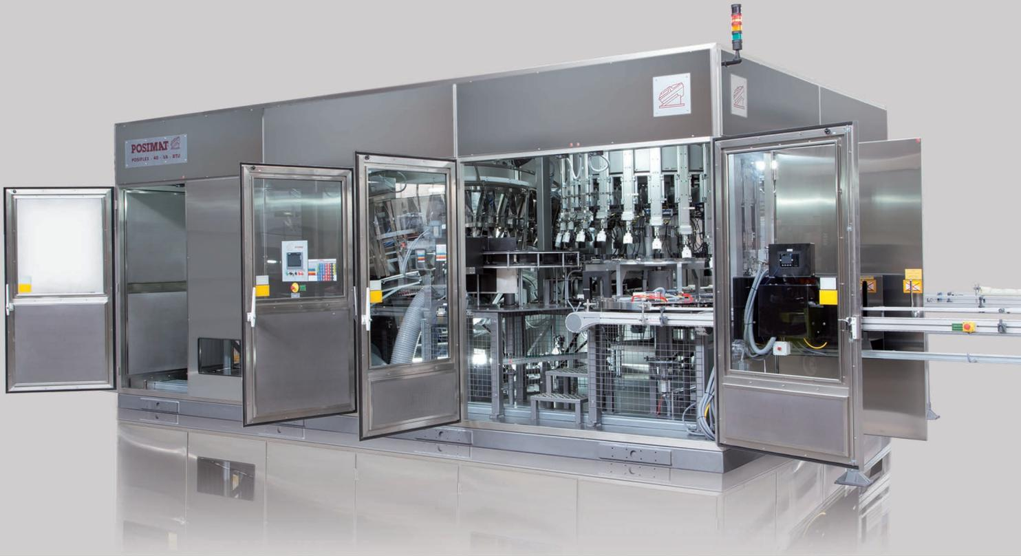
Le système ACCESS dispose d'une **cabine** qui permet **d'accéder à l'intérieur** de l'équipement, ce qui **facilite les tâches** d'inspection, de maintenance et de nettoyage.
