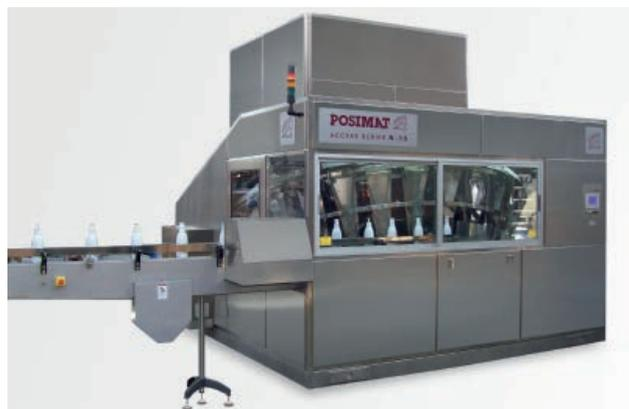
Cabine en acier inoxydable pour redresseur, modèle N-35, avec silo d'alimentation incorporé, monobloc
