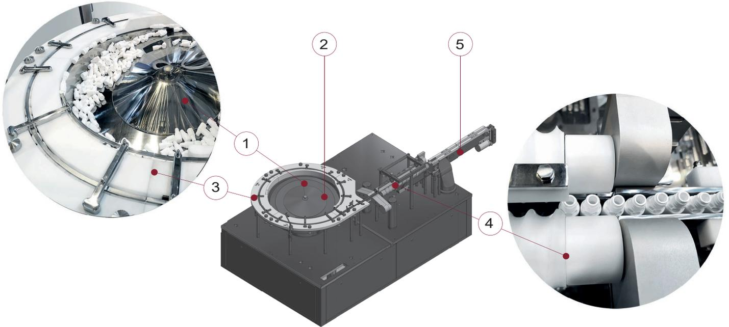
与容器有着直接接触的中心毂 (1) 和内部组件由 AISI 316 不锈钢制成。蜗杆螺钉 (4) 以及和容器直接接触的导向件 (3) 由白色聚甲醛 (POM) 制成。设备表面无边角，适合于制药行业。所有焊缝均光滑并经过电抛光。
